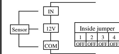
◎Sensor input(NPN 5V/12V)
