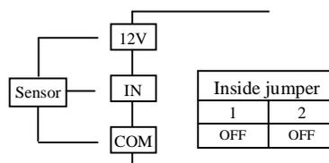
⊙ Sensor input (NPN 5V/12V)
